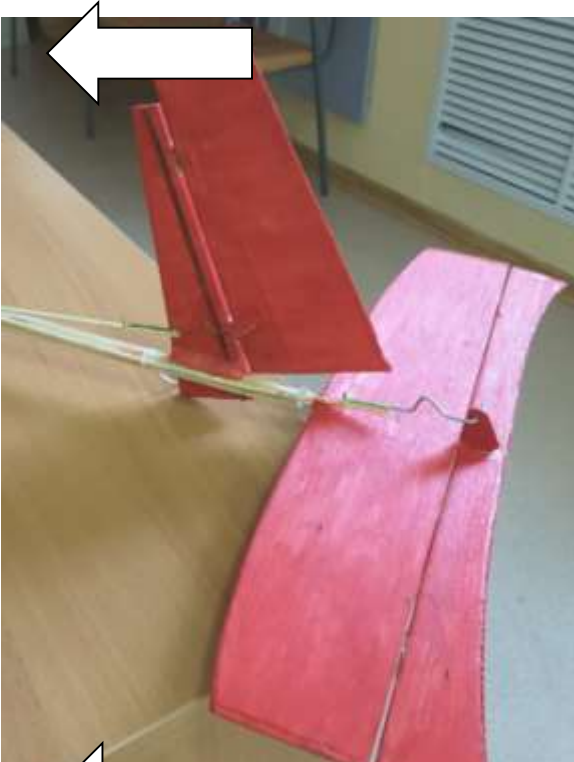
Конструкция хвостового оперения Схематической радиоуправляемой модели электролёта
