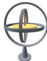
То есть это устройство, которое при любом наклоне предмета, на который установили гироскоп, остаётся в прежнем положении. Оно используется в космических аппаратах, летательных аппаратах, автомобилях – вездеходах, устройствах определения положения в пространстве для видео- и фотокамер и прочего оборудования.
