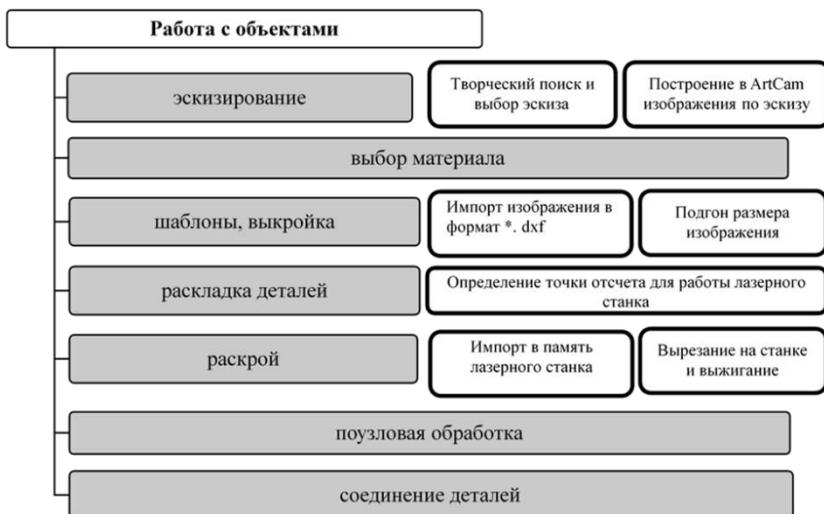
**Рисунок 2 – Процесс изготовления декора в ArtCAM**
